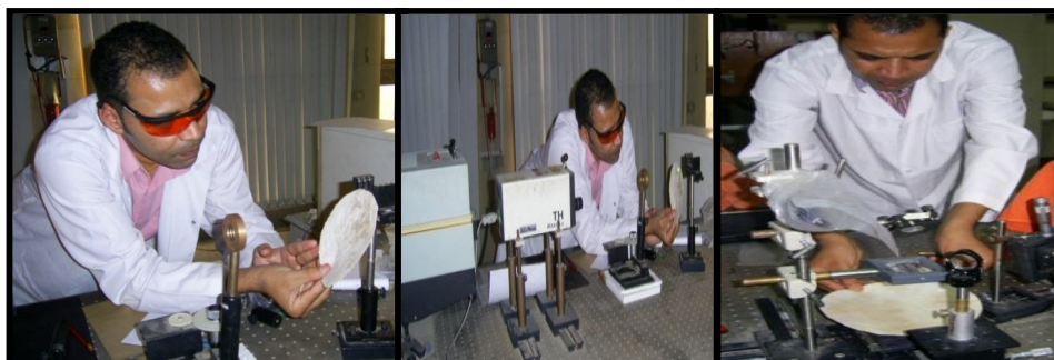
صورة رقم (٣) يوضح تنظيف بقع الـ foxing باستخدام ليزر Green ذات الطول الموجي ٥٣٢ نانوميتر
