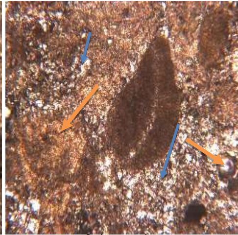
صورة (١٣) تظهر الأصداف الدقيقة وأكاسيد الحديد والمسام غير المنتظمة في الميكرايت C.N (x٦٣)
